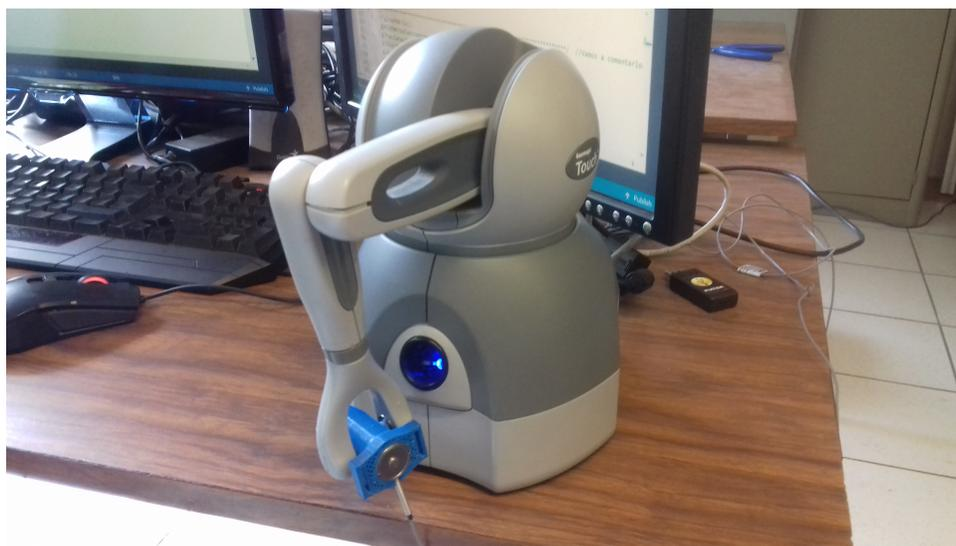
Figura 3.7: Robot con el sensor de fuerza adaptado.
