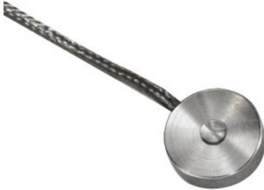
Figura 3.3: Celda de carga modelo LLB300 marca Futek.
