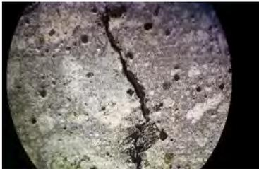
Una compactación deficiente nos lleva a la aparición de este tipo de lesiones, lo cual conlleva a una alta permeabilidad, y un peligro latente a la corrosión del acero. Por otra parte, el exceso de compactación provoca segregación y exudación.
