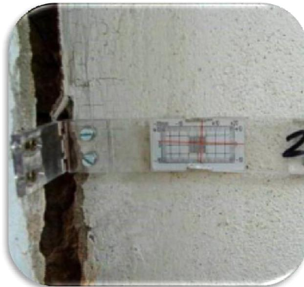
Imagen 50 Medición de Fisuras
