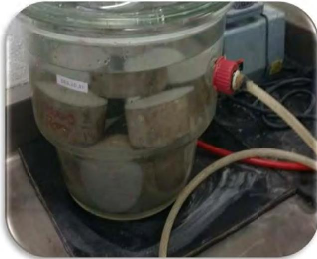
Imagen 61 Preparación de prueba RCPT
