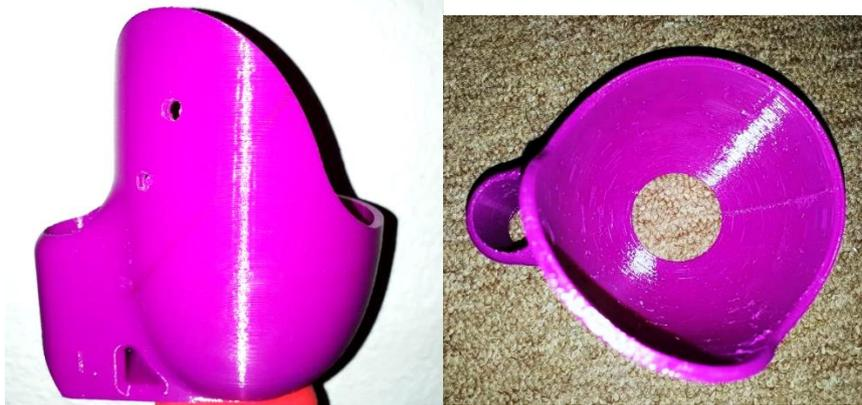
Fotografía 10. Prototipo II de socket.
