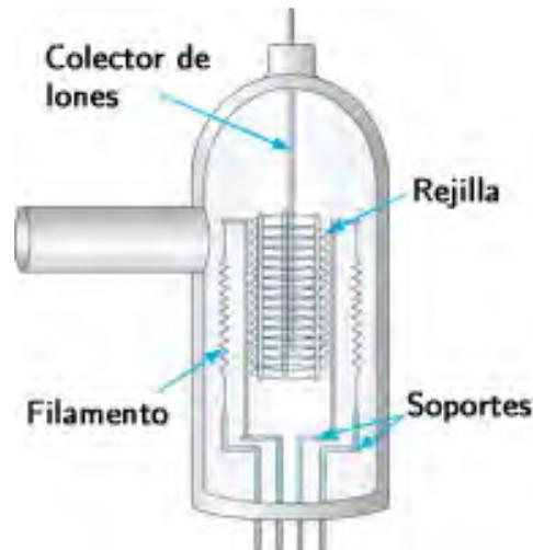
Figura B-2: DIAGRAMA DE UN MEDIDOR DE BAYARD-ALPERT.<sup>[107]</sup>
