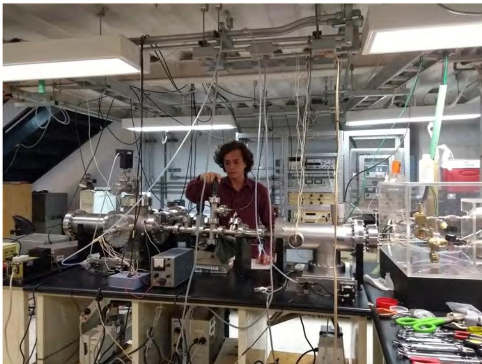
Figura 4-11: AJUSTE DE BANDERA. Al levantar la bandera, se permite el paso de los iones proyectil hacia la cámara de reacción, donde se encuentra el blanco.
