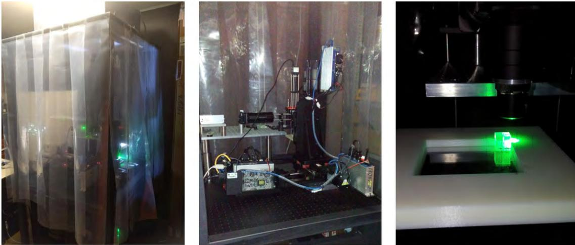
Figura 3.2 Montaje final del sistema de grabado láser, vista exterior e interior del cuarto limpio, y sistema en funcionamiento durante el grabado de un cristal centellador.
