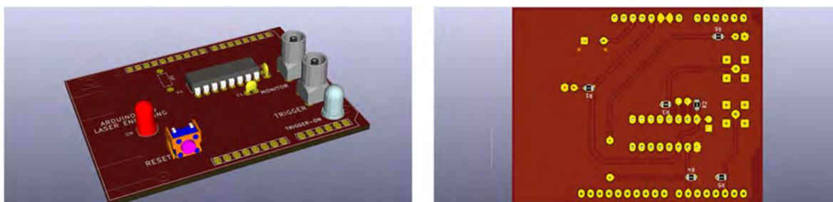
Figura 3.4 Diagramas de la tarjeta realizada para el disparo externo del láser vista tridimensional e inferior
