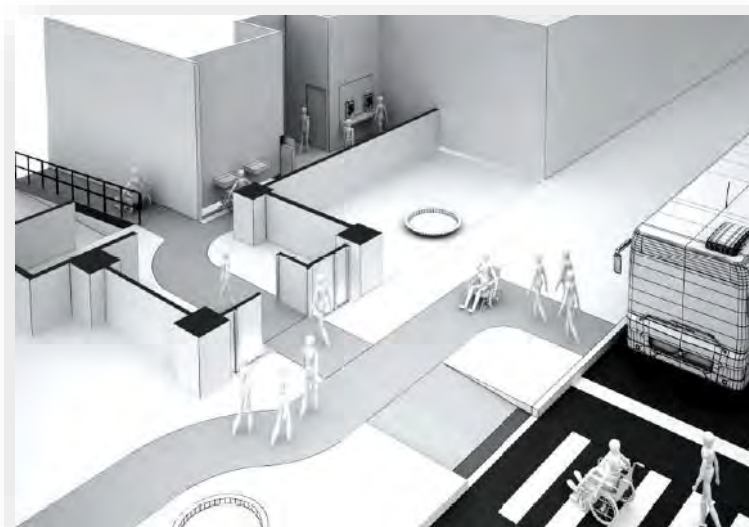
Representación de una ruta accesible en edificación Manual de Normas Técnicas de Accesibilidad 2016
