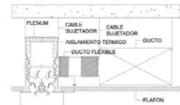
Detalle de Montaje de Difusor Lineal en Plafón
