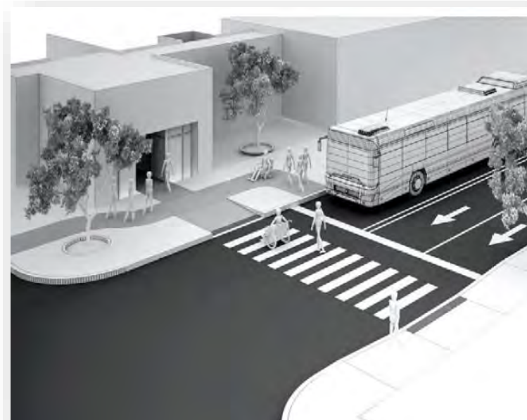
Representación de una ruta accesible en espacio público y al exterior Manual de Normas Técnicas de Accesibilidad 2016
