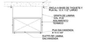
Detalle de Soporte de Ducto Interior
