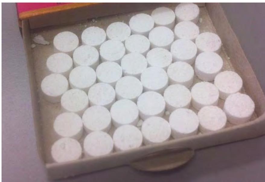
*Figura 32: Fotografía de los andamios obtenidos a partir del poliuretano sintetizado.*
