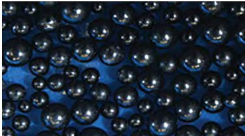
Fig. A 4.10 Apuntalantes de densidad neutral, hechos de termo-plásticos y nano-compuestos. (Usman Ahmed, Nathan Meehan, Unconventional Oil and Gas Resources, Exploitation and Development, 2016).
