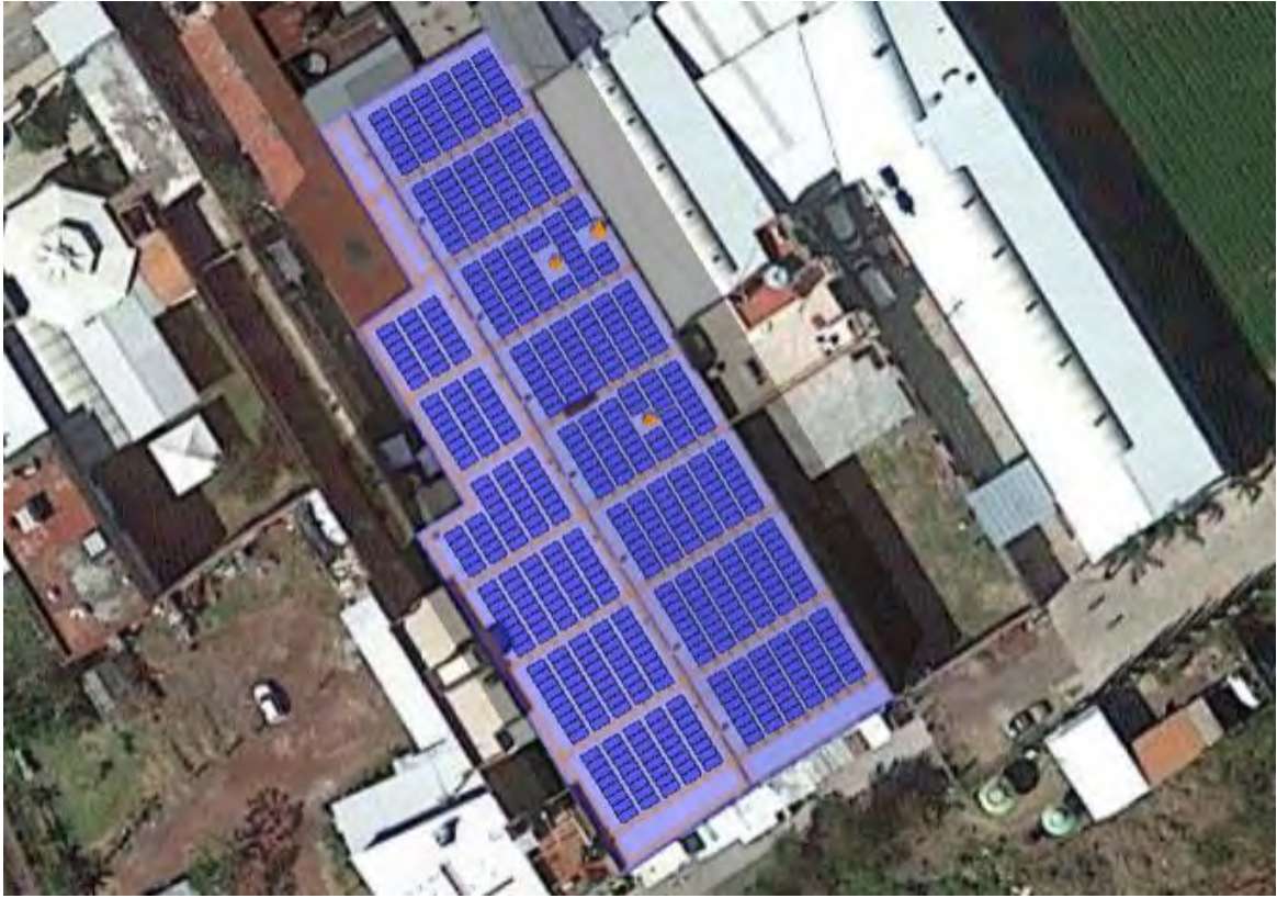
Ilustración 14 Dimensionamiento de Módulos en Planta
