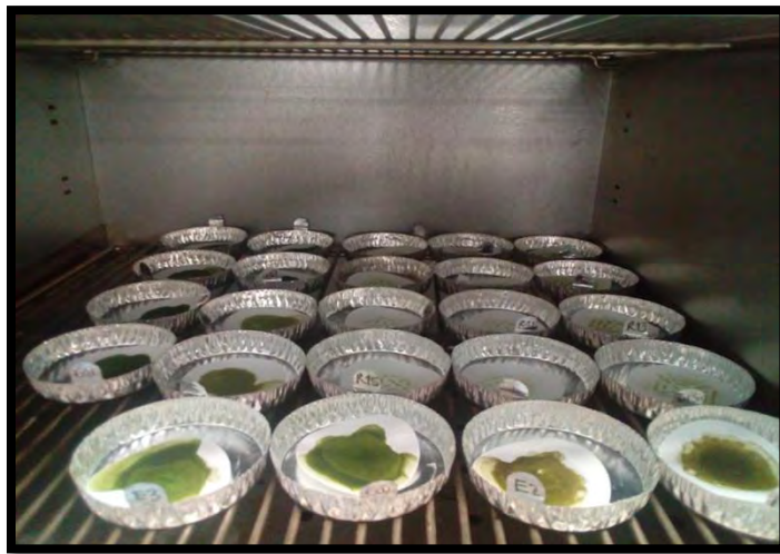
Figura 6: Secado de biomasa en estufa a 105° C
