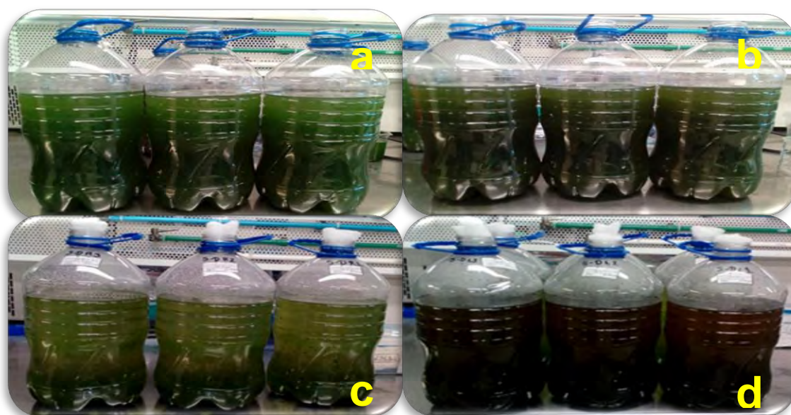
Figura 5: Cultivo de Scenedesmus obliquus en agua residual (a) y agua residual enriquecida con lixiviado (b); cultivo mixto con agua residual (c) y agua residual enriquecida con lixiviado (d); todos los cultivos están al inicio de la experimentación.
