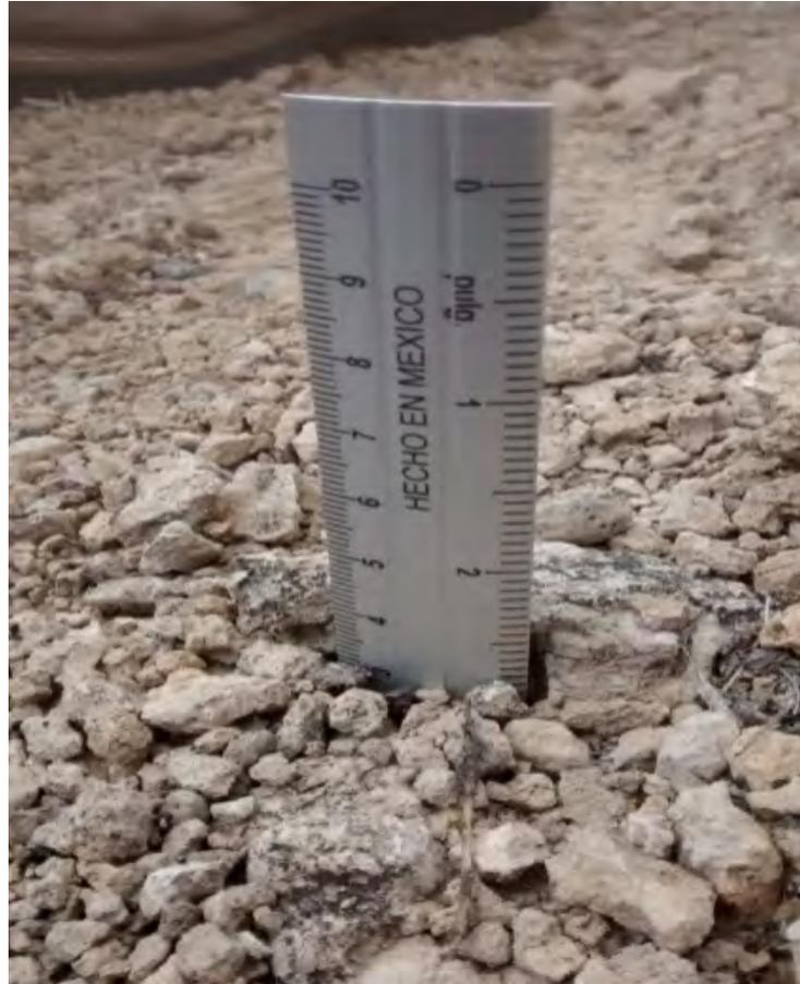
Figura 6. Evaluación de la erosión, por el método de reglas
