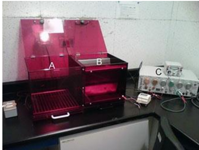
Figura 7. Cámara de evitación inhibitoria. A Compartimento de seguridad. B Compartimento de castigo. C Estimulador de pulsos cuadrados.
