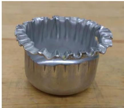
*Figura 1.7.- Pieza embutida desgarrada.*
