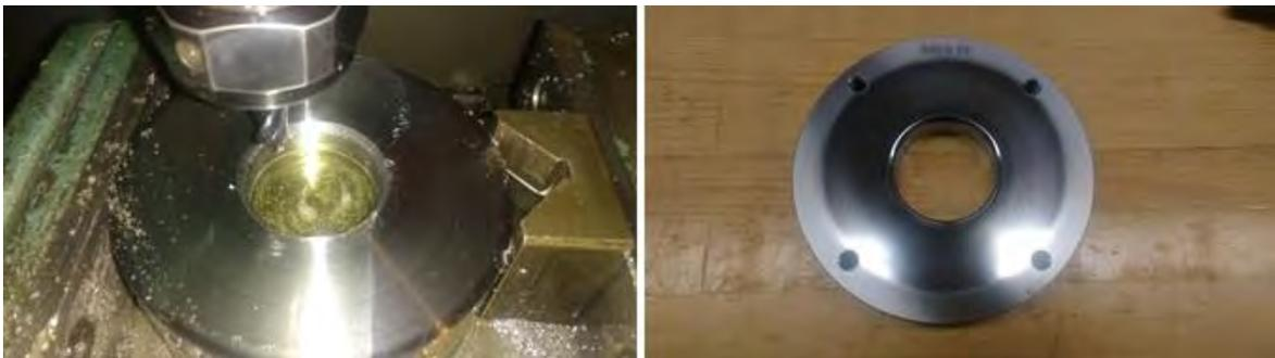
**Figura 3.8.- Matriz manufacturada en fresa CNC y terminada.**
