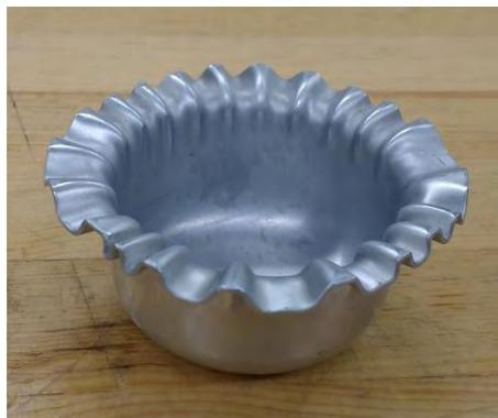
**Figura 1.5.- Pieza embutida con arrugas en la pestaña.**
