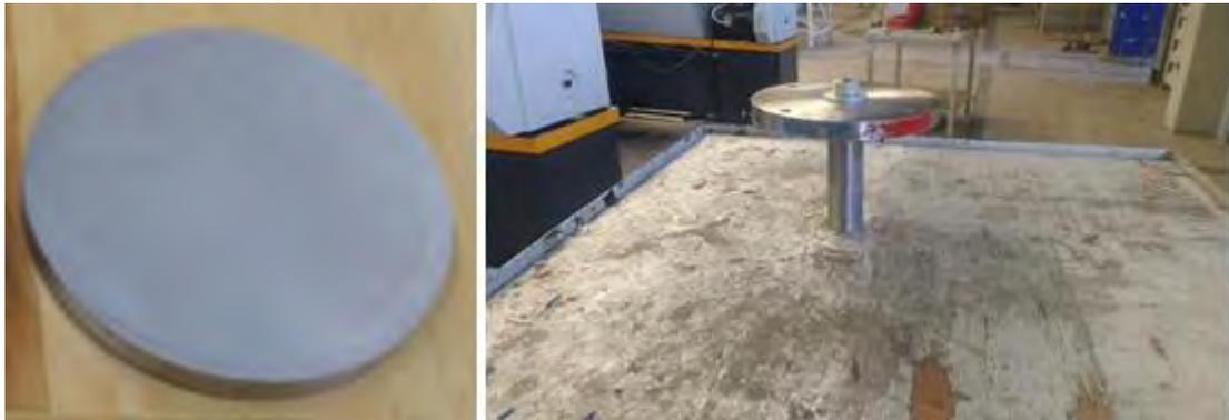
**Figura 3.9.- Pieza en bruto del pisador y pieza del pisador en mandril.**
