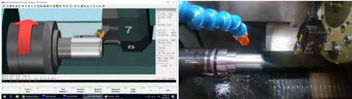
**Figura 3.3.- Punzón en simulador y torno CNC.**
