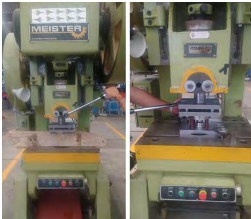
**Figura 4.4.- Alineación del troquel de embutido.**
