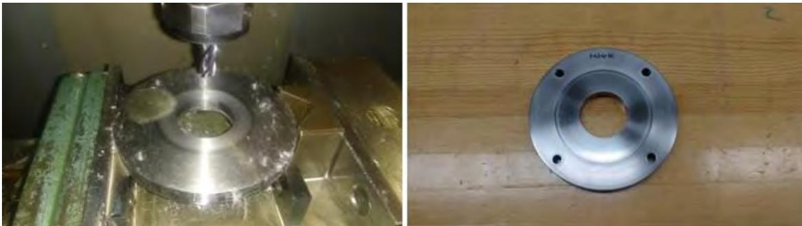
*Figura 3.12.- Pisador manufacturado en fresa CNC y terminado.*
