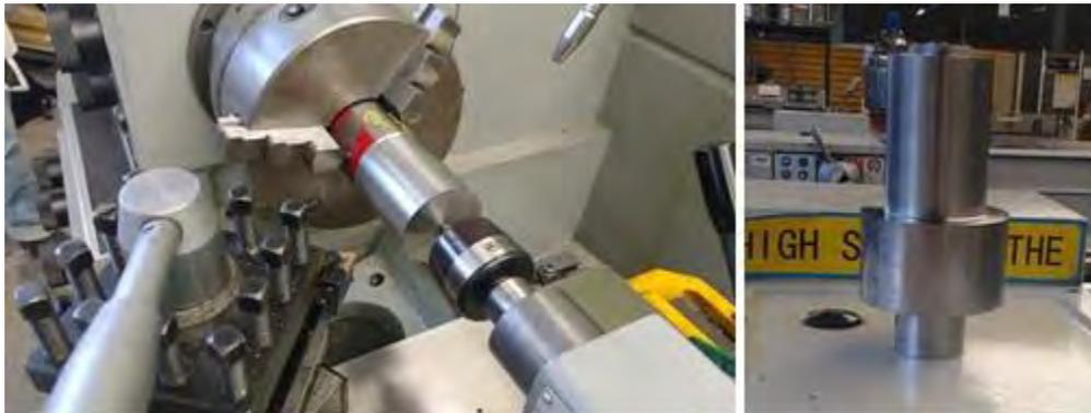
**Figura 3.2.- Pieza (punzón) manufacturado con dimensiones aproximadas.**
