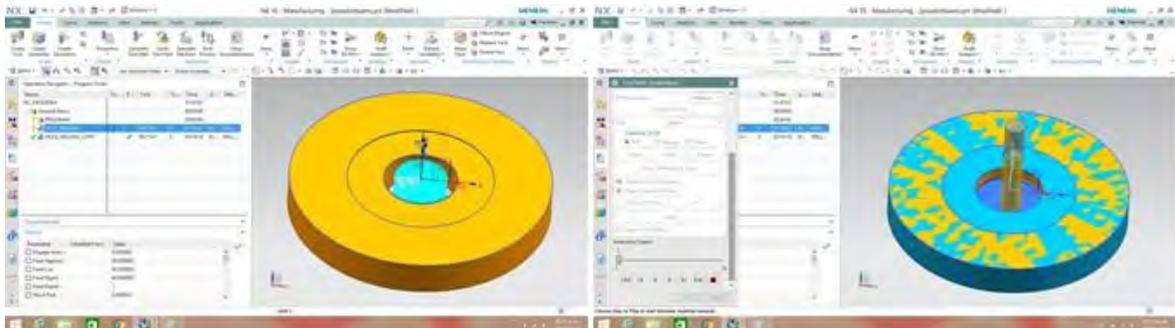
**Figura 3.10.- Generación del código de CNC para la manufactura del pisador de embutido en NX10.**
