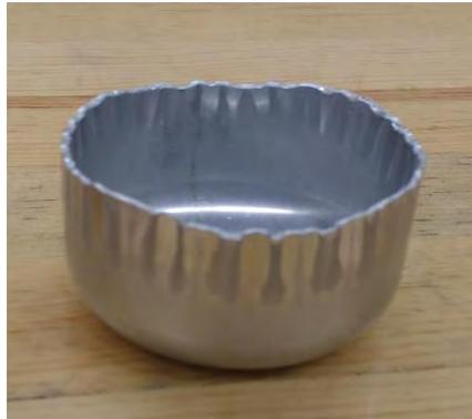
*Figura 1.6.- Pieza embutida con arrugas en la pared.*
