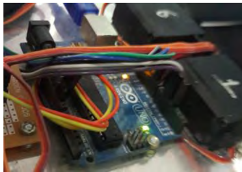
Figura 3.4.6 Fotografía de la tarjeta de control arduino conectado a los servomotores.
