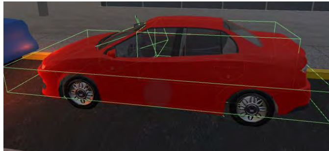
Figura 3.5.19 Imagen que muestra el modelo de colisión tipo caja sobre el auto.
