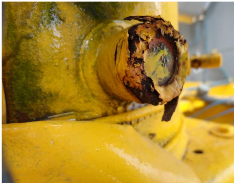
Foto 3.19. Mirilla para revisar nivel de aceite con corrosión.
