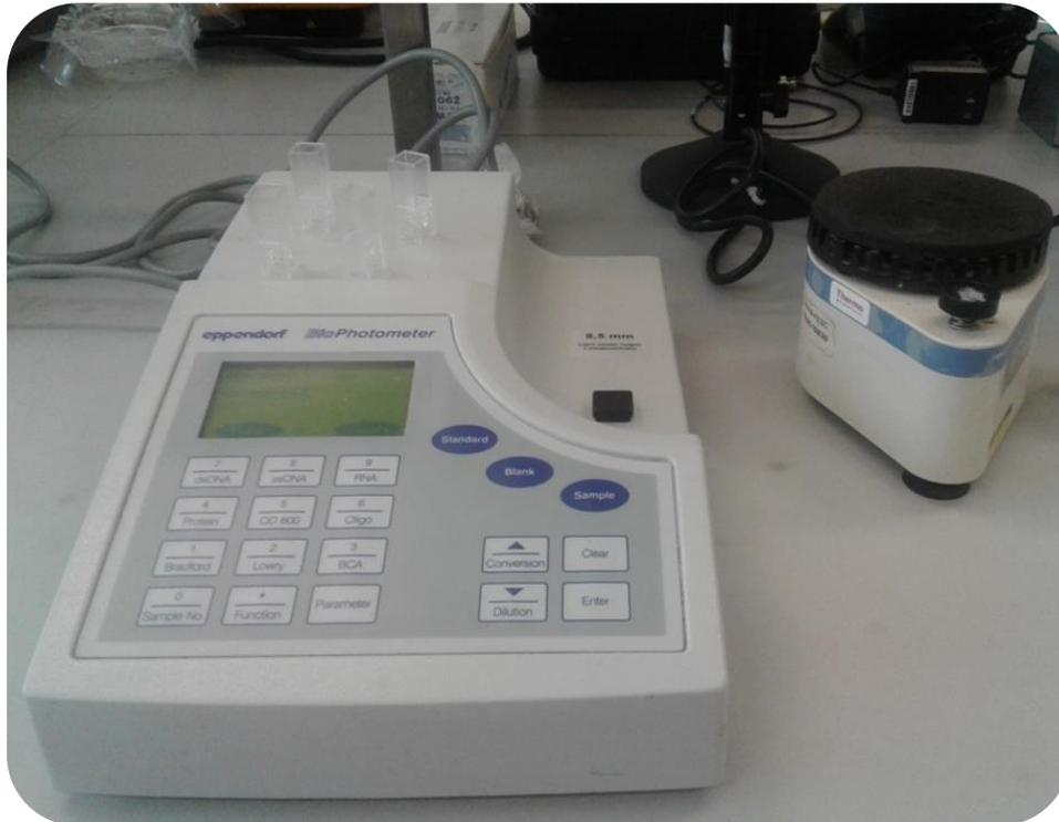
Figura 35. Lectura de absorbancia a  $\lambda_{595 \text{ nm}}$  en Biofotómetro™ plus marca Eppendorf
