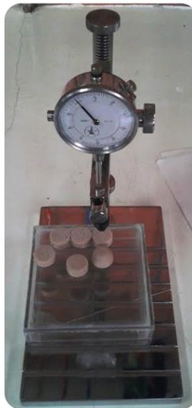
Figura 27. Determinación de dureza con penetrómetro
