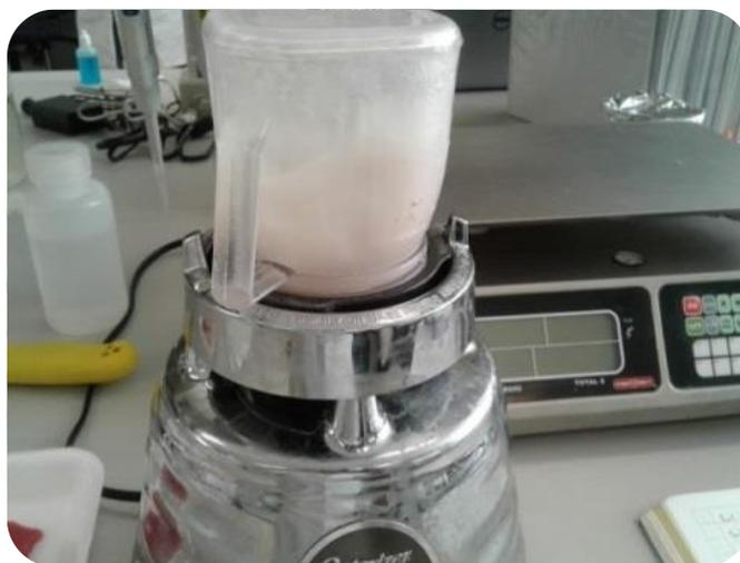
Figura 32. Homogeneización de salchicha con 50 mL de solución buffer de extracción ( $\text{KH}_2\text{PO}_4$  0.3M)
