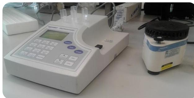
Figura 30. Biofotómetro plus marca Eppendorf y vórtex MaxiMix, para la determinación de absorbancia
