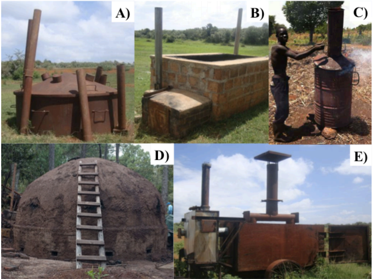
Figura 2.2 Distintos tipos de hornos mejorados. A) Horno de metal, eficiencia 20-38%; B) y D) Horno de ladrillo, eficiencia 27 a 35%; C) Horno de tambor, eficiencia 20 a 38%; E) Horno de retorta, eficiencia 22 a 40%. Eficiencias obtenidas de (FAO 2017), Fotografías obtenidas de Kalenda et al. sin fecha y http://ecofuelafrika.blogspot.mx/ ).
