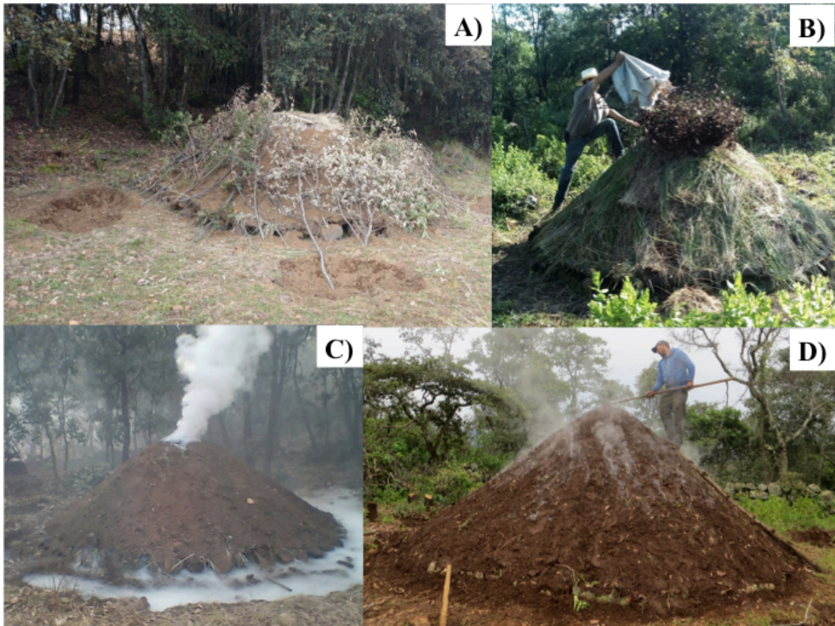
Figura 6.4 Distintos tipos de hornos tradicionales de la cuenca de Cuitzeo. Los hornos A), B) y C) son de tipo encendido por abajo. Junto al horno A) se puede ver cómo se cubre el horno con la tierra justo a lado. La práctica de cubrir el horno con plantas como en A) y B) no siempre se lleva a cabo (Fotografías de Filiberto Sánchez). El horno D) es de encendido por arriba (Foto de T.H. Mwampamba).
