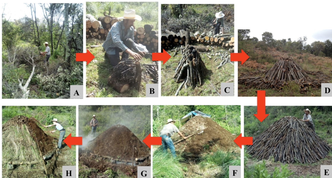
Figura 6.3 Proceso general de fabricación de horno de tierra: A) corte de madera; B), C), D), E) acomodo de horno; F) G) tapado de horno; H) cubrir horno con plantas (A,B,C,E,F,G,H Fotos de F. Sánchez; D Foto de T.H. Mwampamba).
