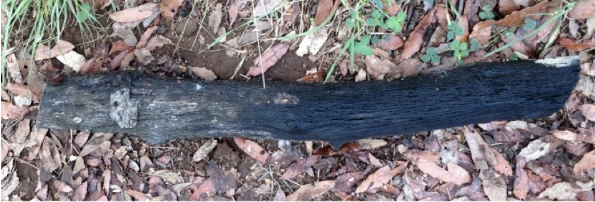
Figura 6.6 Una “pata” o madera cuya carbonización quedó trunca (Foto propia).
