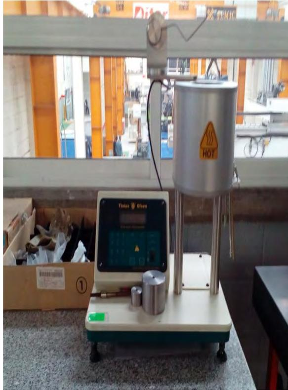
Figura 7. Plastómetro TINIUS OLSEN (DTE-IM-021).
