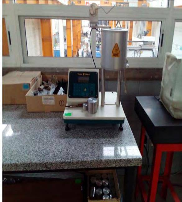
Figura 12. Ajuste del nivel del pistón.
