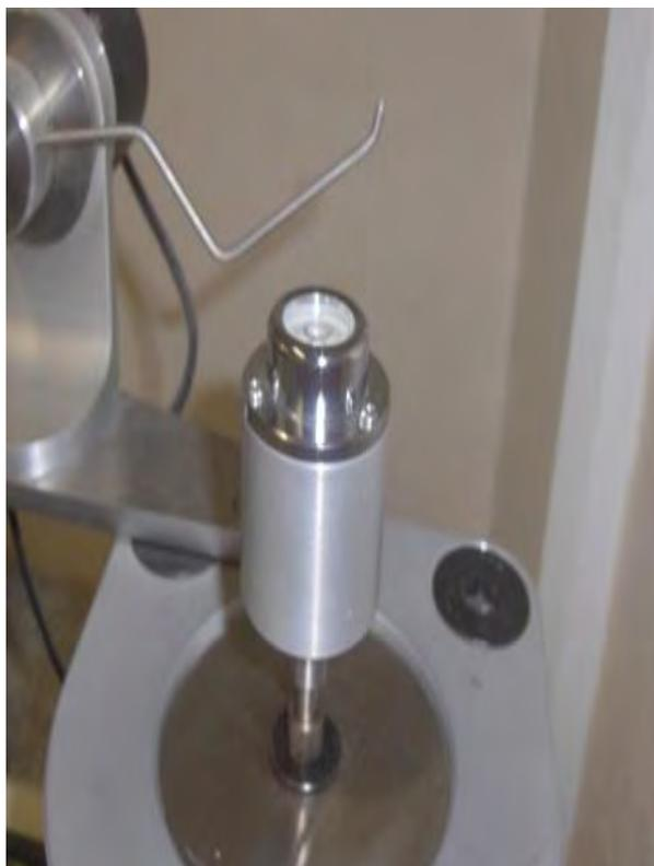
Figura 11. Ajuste del nivel del pistón propiedad de la organización “DITER”
