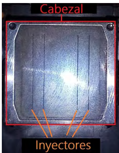
Imagen 25.- Vista frontal de un cabezal de una impresora de inyección de tinta donde se observan los inyectores.
