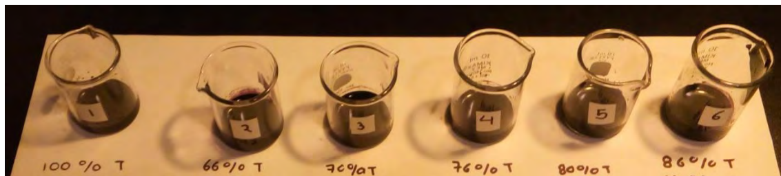
Imagen 42.- Fotografía de los vasos con diferentes tintas radiopacas donde se indica cual fue el porcentaje de tinta con la que se fabricaron.
