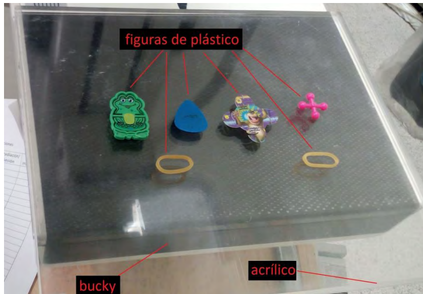
Imagen 34.- Fotografía de los objetos de plástico sobre dos bloques de acrílico montados sobre el bucky del mastógrafo.
