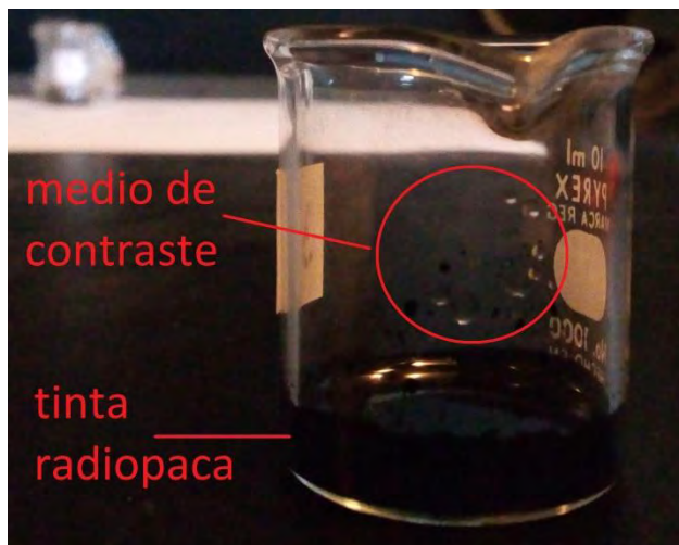
Imagen 44.- Fotografía de un vaso de precipitados con tinta radiopaca de concentración 34% medio de contraste. Se observan gotas de medio de contraste que se separaron de la mezcla.
