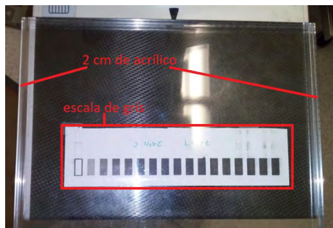
Imagen 47.- Vista superior de escala de grises impresa utilizando la tinta 1 sobre el bucky del mastógrafo. Esta escala está entre dos bloques de acrílico de 1 cm de espesor.
