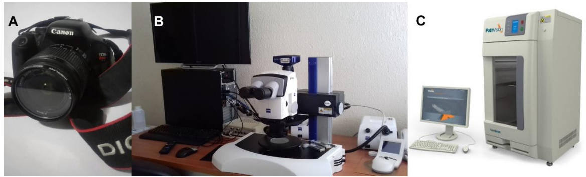
Figura 14. Equipo utilizado para el registro fotográfico. A) Cámara Canon EOS Rebel T3i. B) Estereomicroscopio modular Discovery V12. C) Gabinete de rayos X Ultra Focus.
