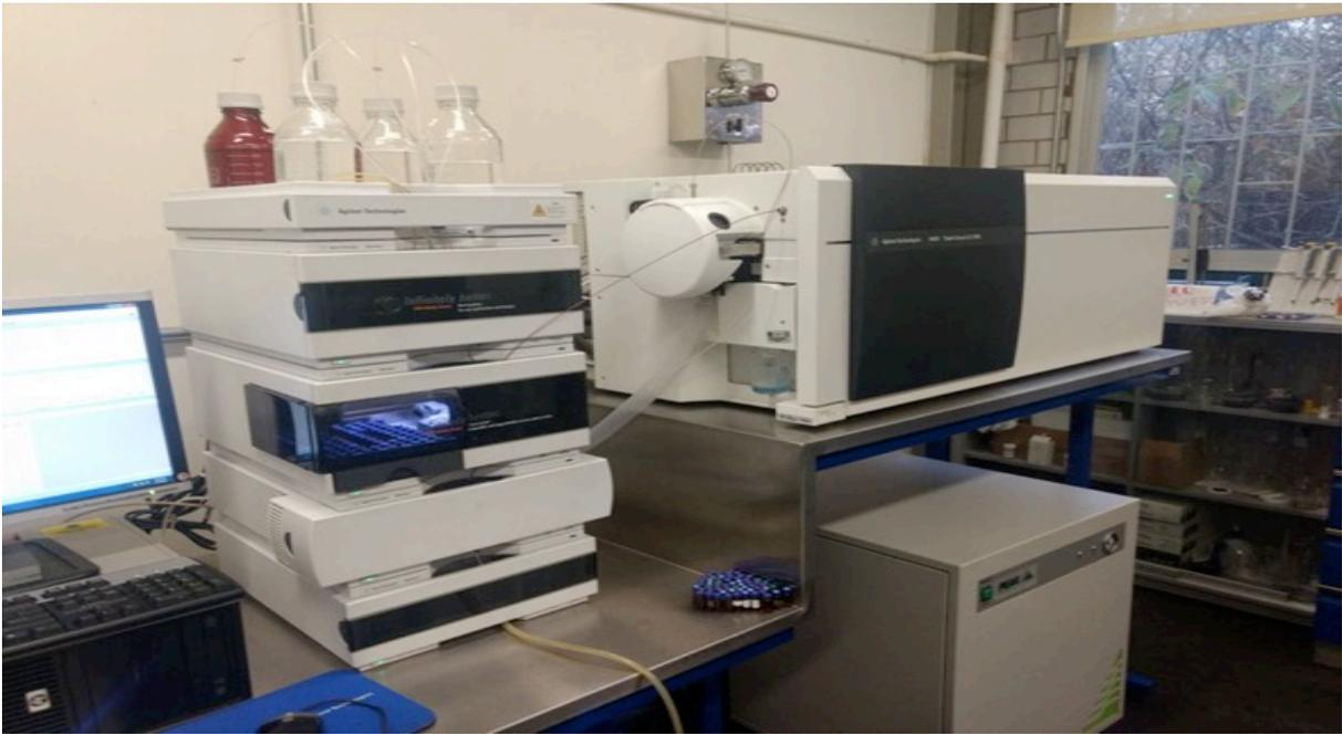
**Figura 2.5** Equipo de cromatografía líquida de alta eficiencia acoplado a un detector de masas
