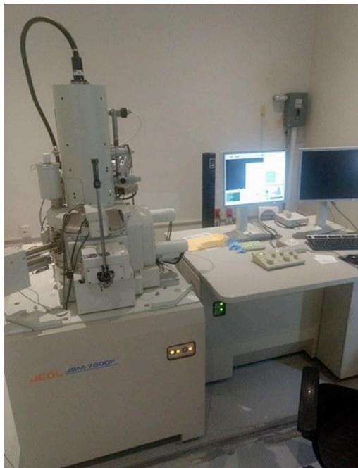
**Figura 2.3** Equipo de microscopía electrónica de barrido (SEM)
