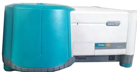
Figura VII.16. Vista frontal del fluorímetro.
