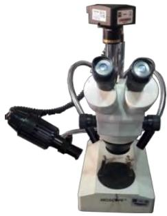
Figura VII. 6. Microscopio estereoscópico utilizado para medir las dimensiones de las muestras
