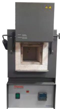
Figura VII.12. Mufla utilizada para el añejamiento térmico de las muestras cristalinas. La mufla cuenta con controles electrónicos para ajustar la temperatura de operación.
