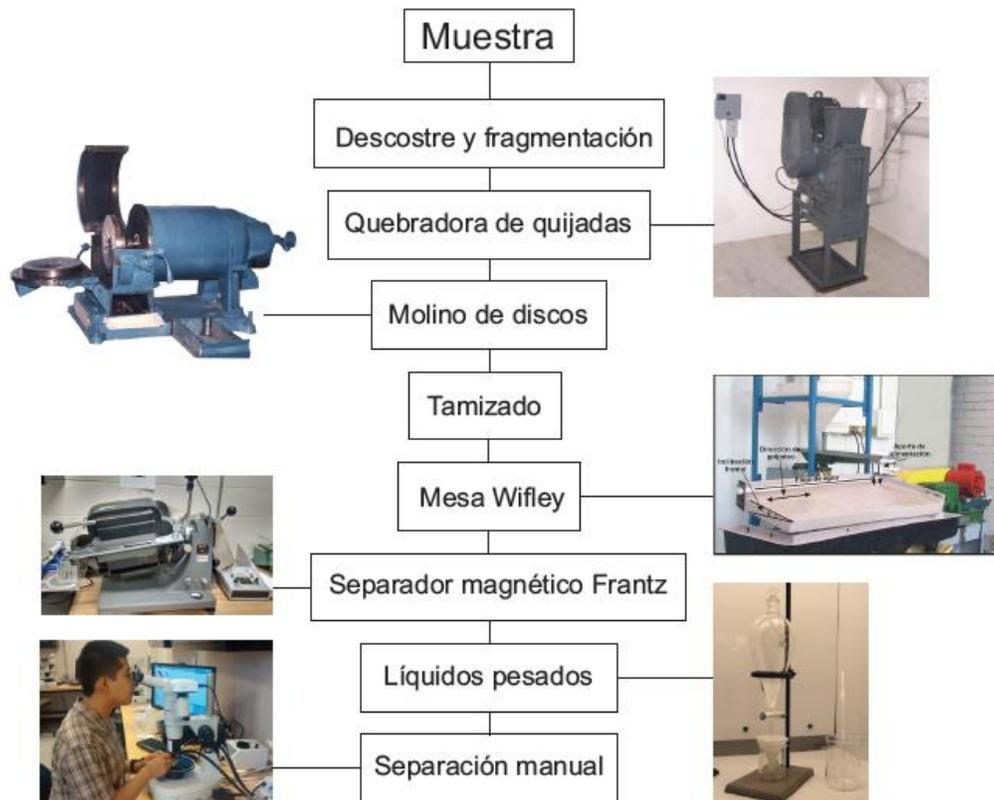
Figura 3.3. Proceso de separación de circones y apatitos.
