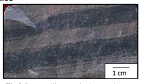
**Fig.8.** Roca arcillosa con horizontes ricos en materia organica e hidrocarburos.
