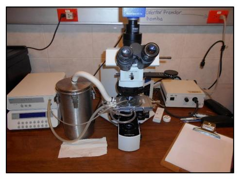
**Fig.6.** Equipo para la medición de inclusiones fluidas. Se observa una platina térmica marca THMSG 660 adaptada a un microscopio petrográfico. El microscopio presenta una cámara que transmite las imágenes en una televisión de plasma.
