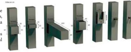
Ménsulas "largas" o voladizas: elementos estructurales que por su longitud horizontal funcionan como una viga, es decir, a flexión.
