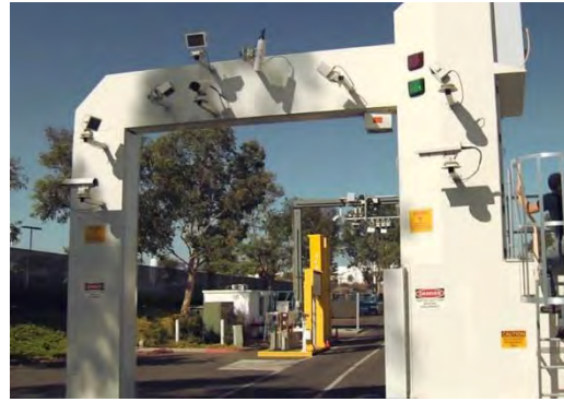
Imágenes de los portales de rayos x usados para el escaneo de contenedores y camiones. Extraídas de: LEIDOS - VACIS IP6500 Cargo Inspection System.
