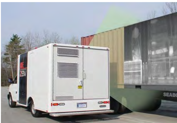
Imágenes de los portales de rayos x usados para el escaneo de contenedores y camiones. Extraídas de: LEIDOS - VACIS IP6500 Cargo Inspection System.
