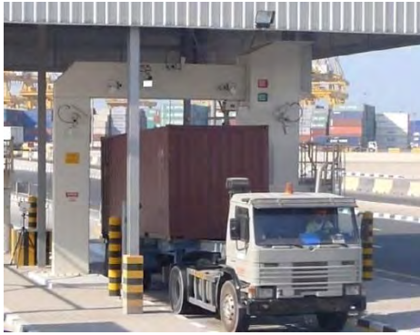
Imágenes de los portales de rayos x usados para el escaneo de contenedores y camiones. Extraídas de: LEIDOS - VACIS IP6500 Cargo Inspection System.
