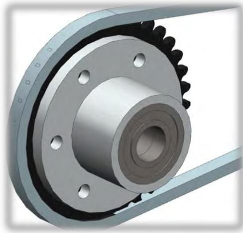
Figura 81 Interferencia nula de la cadena con la brida.
