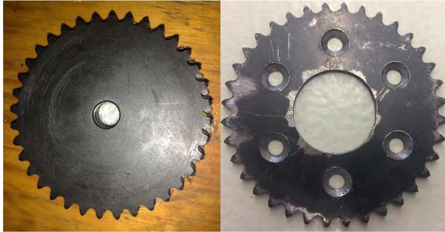
Figura 82 a) Sprocket #25 de 36 dientes comercial, b) modificado.
