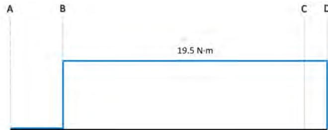
Figura A5-6 Magnitud del momento torsional del eje del reductor.
