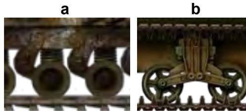
*Figura 48 Ejemplos de bogies en tanques de guerra.*
