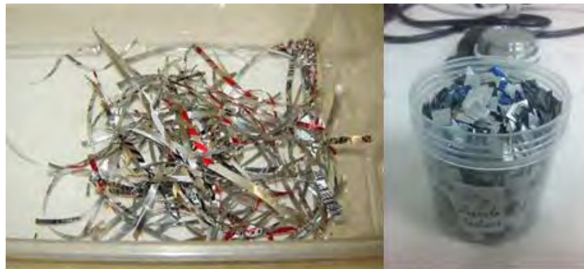
a) Figura 4.2a) Latas de Al recortadas manualmente en tiras. b) Figura 4.2b). Latas de Al recortadas en hojuelas
