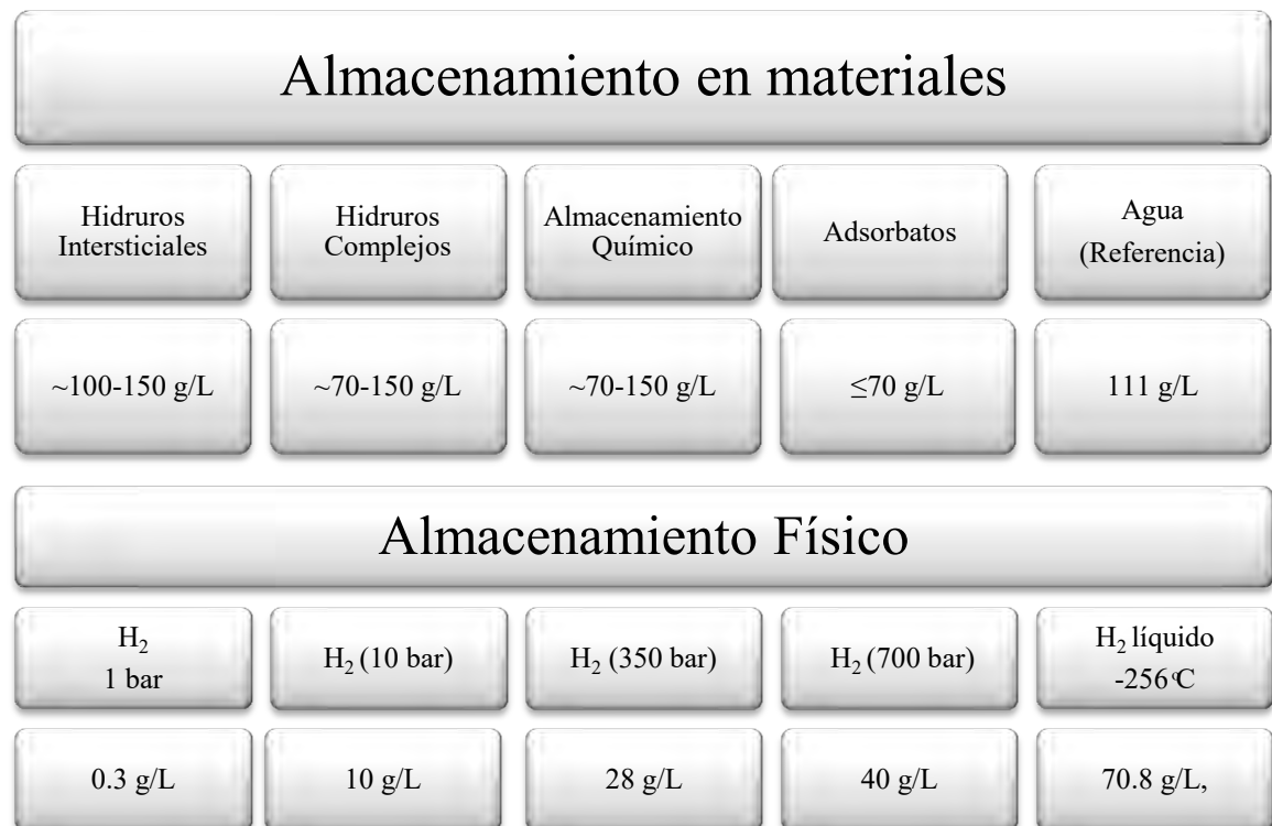
Figura 3.2 Comparativa de densidades de hidrógeno de los principales métodos de almacenamiento 24 .
