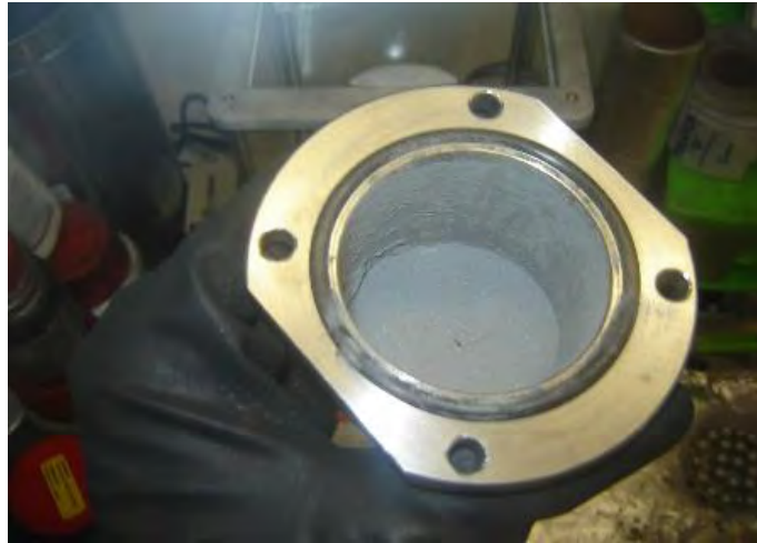
Figura 4.3 Apariencia del polvo de Al después de 10 horas de molienda.
