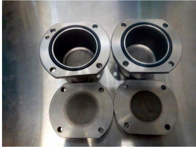
Figura 3.14. Viales de acero inoxidable 316L para molino planetario.
