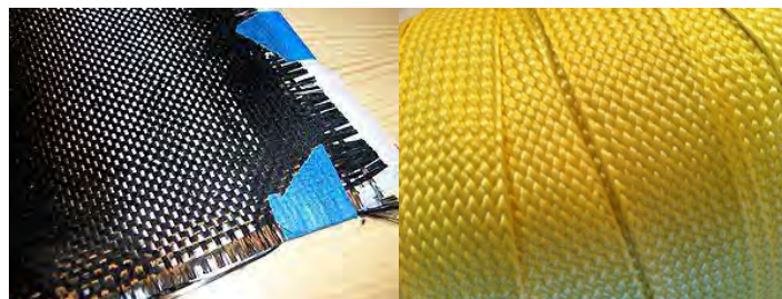
Figura 1.20 Ejemplo de una matriz polimérica y una fibra para la elaboración de un material híbrido, fibra de carbono (izquierda) y kevlar (derecha).
