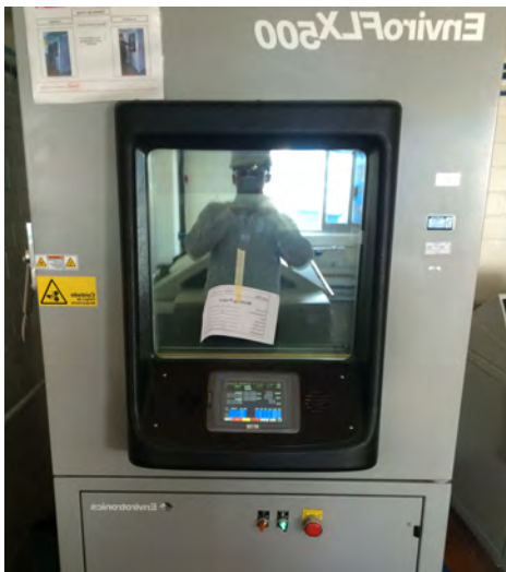
Figura 5.5.1. Cámara de ciclos.
