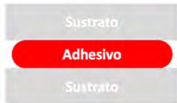
Figura 2.3.1. Esquema de una unión adhesiva.
