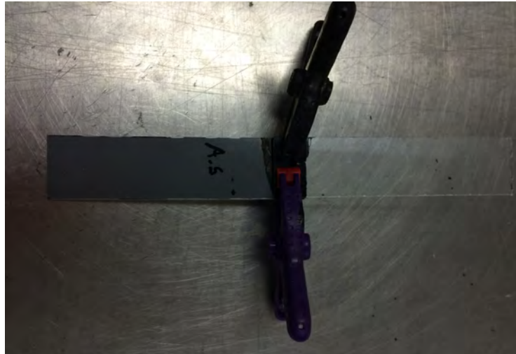
Figura 5.4. Ensamble aluminio pintado – vidrio (probeta).
