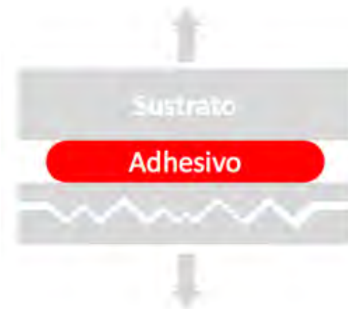
Figura 2.3.2.3. Esquema básico de una falla de sustrato.
