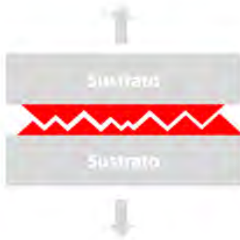
Figura 2.3.2.2. Esquema básico de una falla cohesiva
