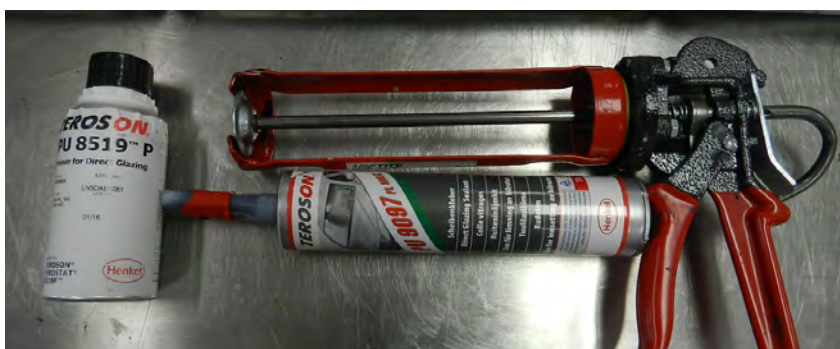
Figura 5.3.1. Pistola galafateadora, cartucho de adhesivo PU y primer.
