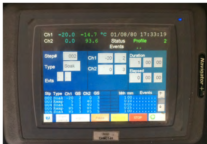
Figura 5.5.2. Pantalla de control de la cámara de ciclos.
