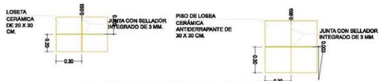
04 DETALLE DE JUNTA EN PISO Y MURO
