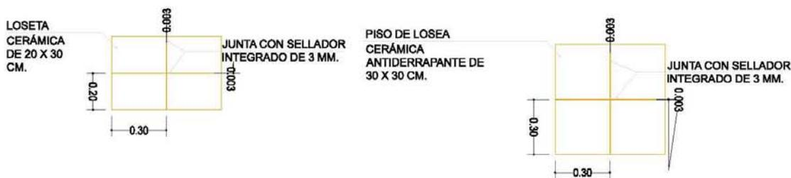
**04 DETALLE DE JUNTA EN PISO Y MURO**
