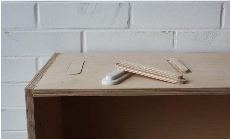
Elementos de unión de módulos propuestos en dos materiales diferentes para probar su funcionamiento. Se usan a manera de caja y espiga, con la lengüeta hacia arriba para unir los módulos y con la lengüeta hacia abajo cuando está en desuso.
