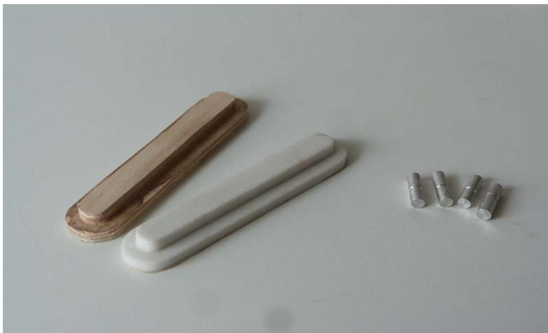
Elementos de unión para módulos desarrollados en dos materiales diferentes: triplay y silicón.
