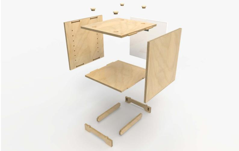
Módulos RTA (Estas siglas en inglés significan "ready to assemble" que significa "listos para ensamblar". Los muebles desarrollados bajo este sistema se venden desarmados en una caja, para facilitar su movilidad. El usuario puede armarlos en casa con herramienta básica.
