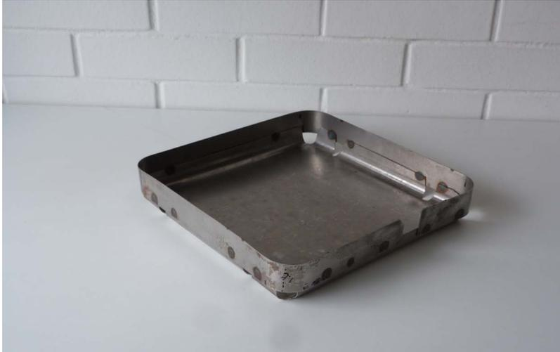
Accesorio de lámina diseñado a partir de dos partes. Charola con radios profundos y pared alta.
