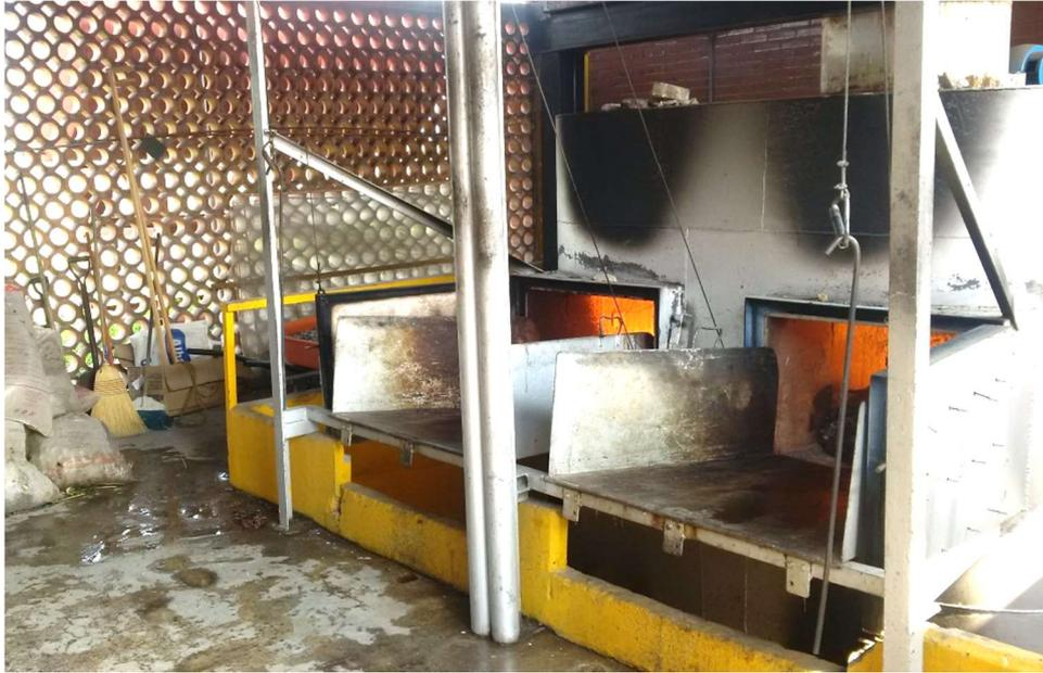
**Figura 14** (A). Cámara del incinerador abierta. (B). Bomba de diésel
