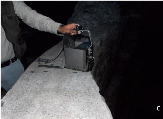
Figura 16 Toma de muestra Pozo en uso, Jardín Botánico Helia Bravo. (a) Se observa la profundidad del pozo. (b) Toma de parámetros fisicoquímicos (c, d) Obtención de muestra de sedimento utilizando draga Li Hau F., 2018.
