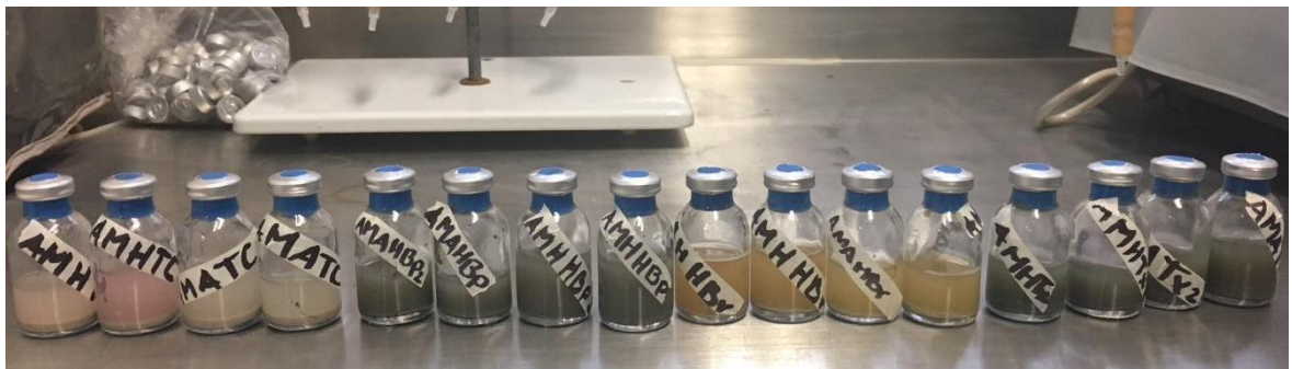
Figura 20 Medios de cultivo para AMH y AMA (Antes de ser inoculados), de izquierda a derecha por sitio: TC, HBp, HBr y TX. Se observa la coloración diferente de cada uno debido al contenido mineral de la fase acuosa Li Hau F., 2018.
