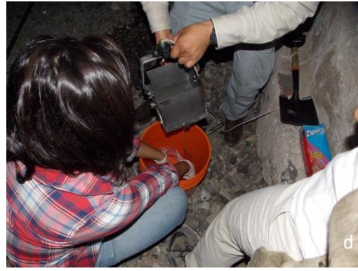
Figura 16 Toma de muestra Pozo en uso, Jardín Botánico Helia Bravo. (a) Se observa la profundidad del pozo. (b) Toma de parámetros fisicoquímicos (c, d) Obtención de muestra de sedimento utilizando draga Li Hau F., 2018.
