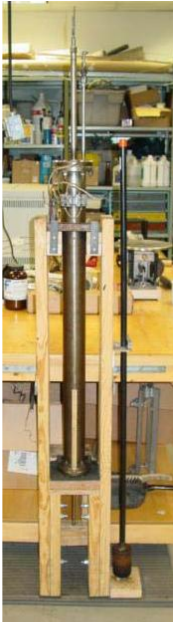
Figura 2.5.1: Tubo de combustión tomado de la literatura [9, 6].
