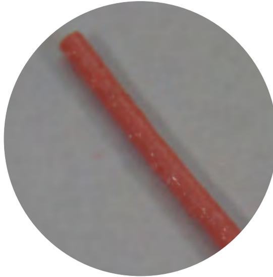
Figura 25. Imagen de microscopía óptica (2x) del filamento de la HAP (50 % m/m) en el PLA por extrusión con un diámetro de  $(1.75 \pm 0.05)$  mm.
