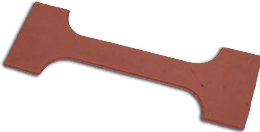
Figura 33. Probeta del material compuesto HAP-PLA para la prueba de la resistencia a la tensión.
