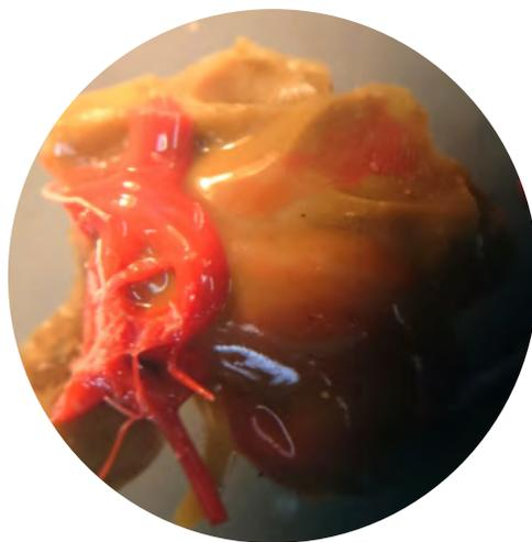
Figura 27. Imagen de microscopía óptica (2x) del material HAP-PLA sometido a temperaturas superiores a los 230 °C.
