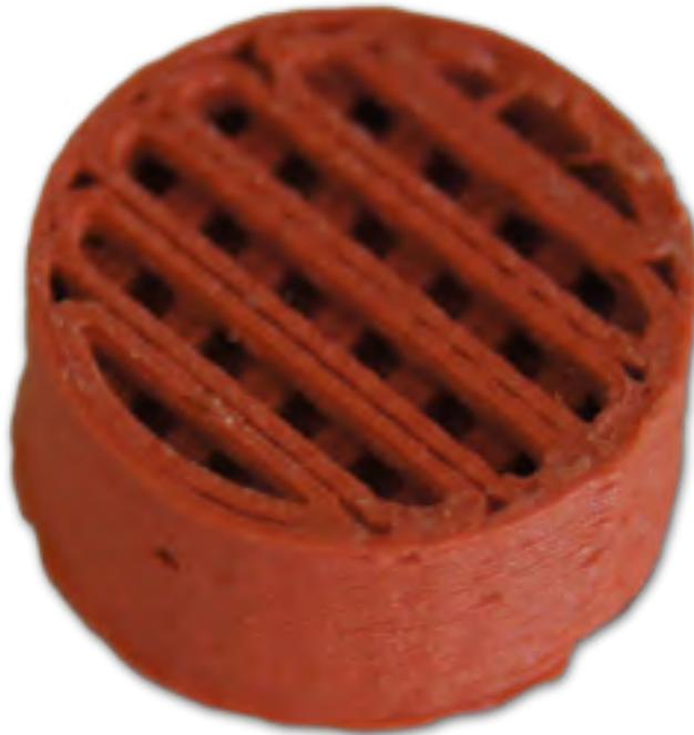
Figura 28. Imagen de microscopía óptica (2x) del andamio construido por impresión 3D de la HAP (50 % m/m) en el PLA con PVA.
