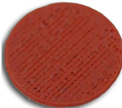
Figura 35. Probeta de HAP-PLA para la prueba de microdureza Vickers.
