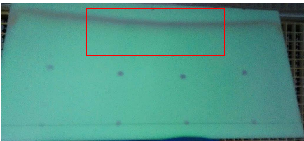
Figura 3.14. Placa revelada de la formulación en ciclado térmico donde se observa que el frente de elución es superior en los extremos que en el centro de la placa.
