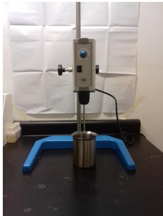
Figura 14. Agitación mecánica del TEOS con el aceite.
