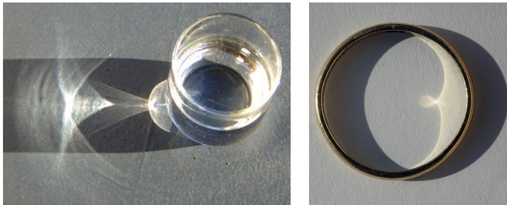
Figura 1.1: Fotografías que muestran superficies cáusticas. A la izquierda, cáustica producida por refracción (diacaústica)[37]. A la derecha, cáustica producida por reflexión (catacaústica) [38].
