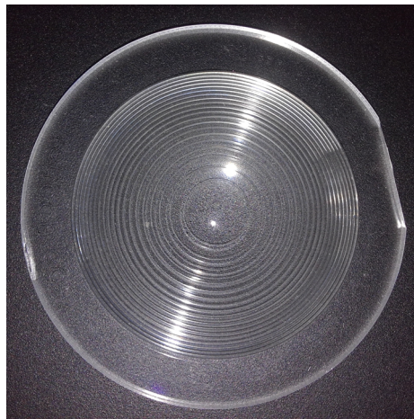
Figura C.1: Lente de Fresnel evaluada experimentalmente mediante pantallas nulas.
