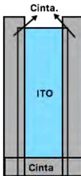
Figura 3.1: Construcción de marco de cintas adhesivas.
