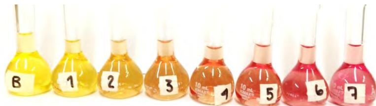
**Figura 6. Curva de calibración**
