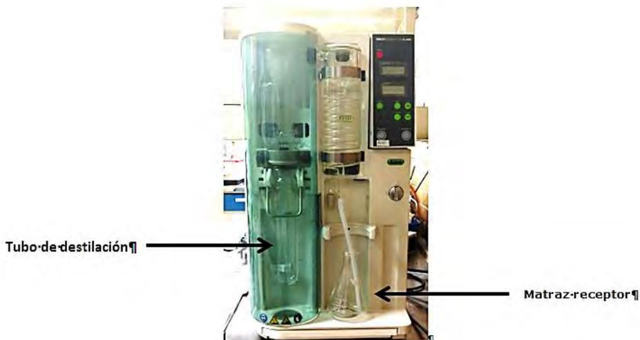
**Figura 8. Unidad de destilación K-355**
