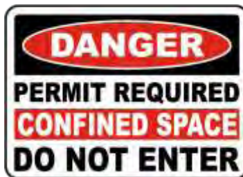
Ilustración 3. Señalamiento para espacios confinados.
