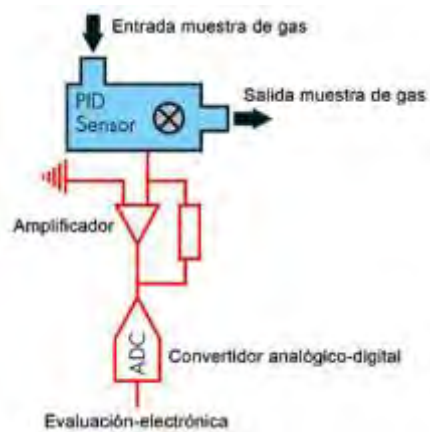
Ilustración 35.Arreglo de un equipo de fotoionización.
