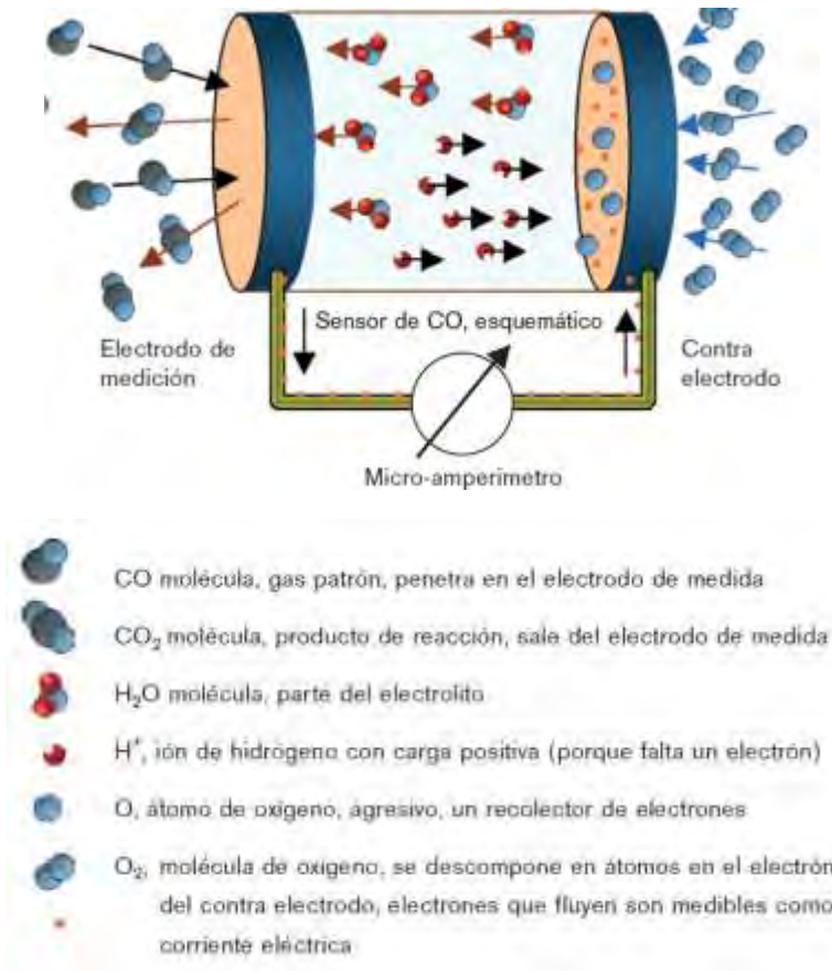
Ilustración 33. Funcionamiento de un sensor electroquímico.
