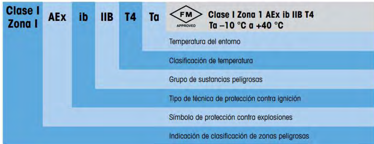
Ilustración 42. Normativa de seguridad NEC 505.
