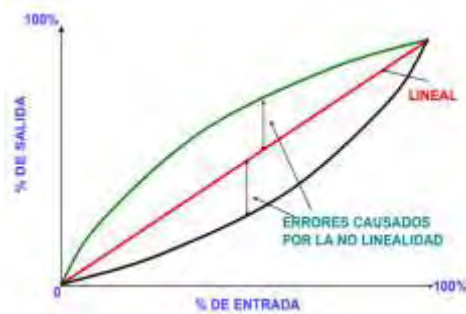
Ilustración 21. Errores causados por la no linealidad de un Instrumento de medición.
