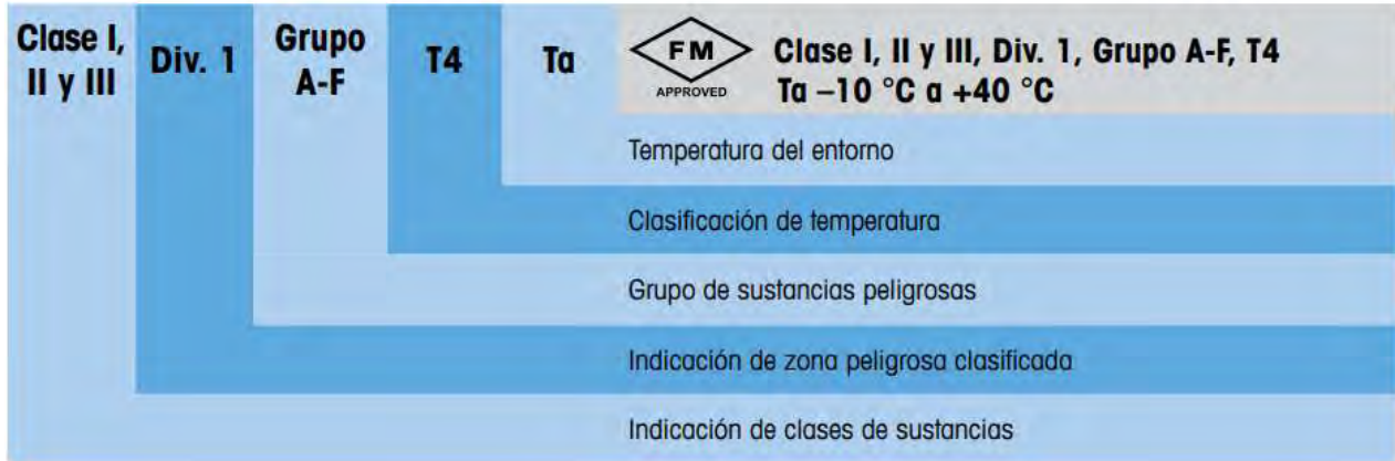
Ilustración 41. Normativa de seguridad NEC 500
