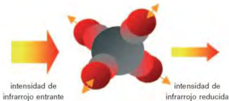
Ilustración 30. Molécula de gas durante la detección infrarroja.
