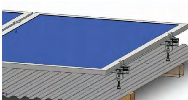
Figura 3.27. Montaje en techo por separado.
