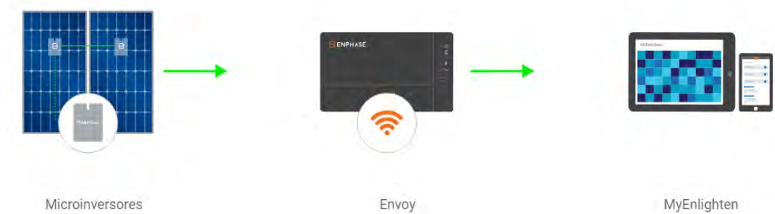
Figura 3.12. Monitoreo de un SFVI con microinversor.
