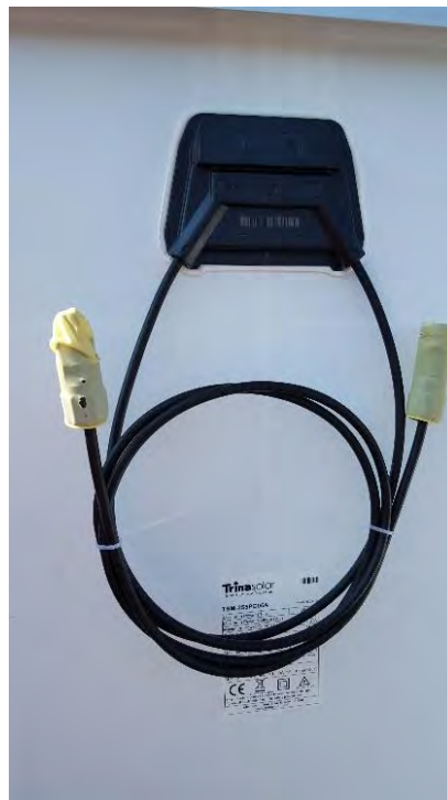
Figura 5.4. Parte de atrás del panel fotovoltaico.
