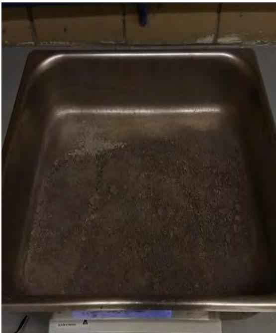
Fotografía 30. Residuo sólido de la lixiviación de Pb
