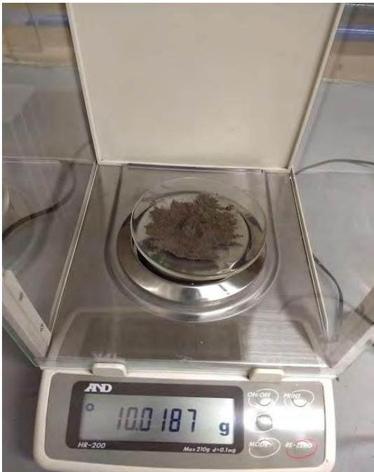
Fotografía 21. Pesado de la muestra de concentrado tostado
