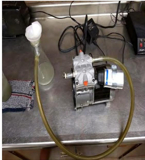
Fotografía 37. Filtración al vacío de la solución lixivante de cobre
