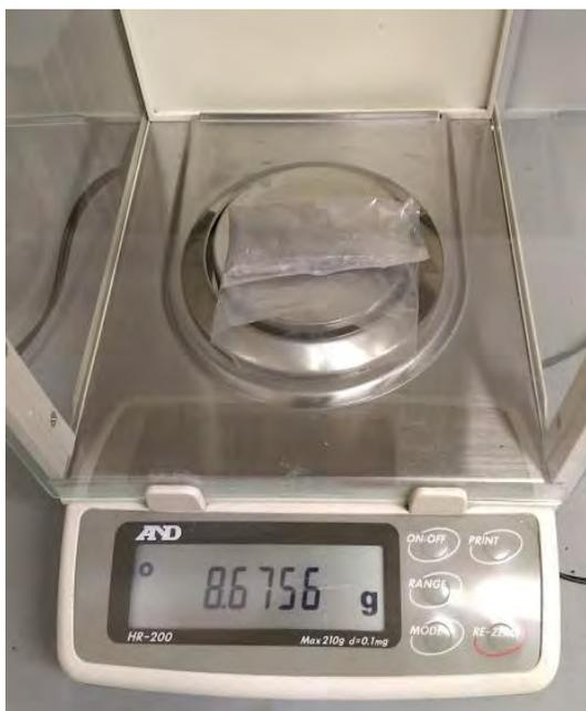
Fotografía 32. Pesado del residuo de la lixiviación con ácido sulfúrico
