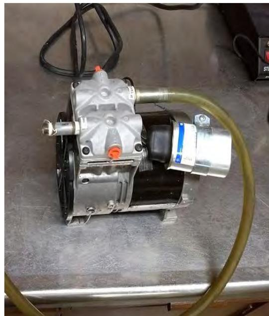
Fotografía 16. Bomba de filtrado al vacío de 1HP
