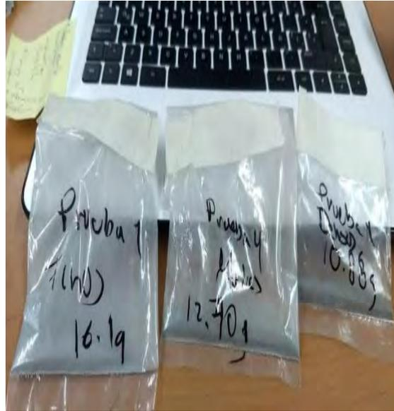
Fotografía 48. Fracciones obtenidas de la concentración gravimétrica
