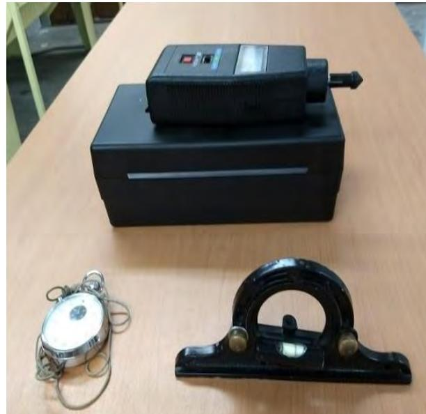
Fotografía 46. Tacómetro, inclinómetro y cronómetro
