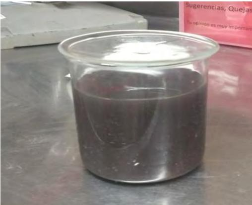
Fotografía 39. Cementación de cobre con hierro
