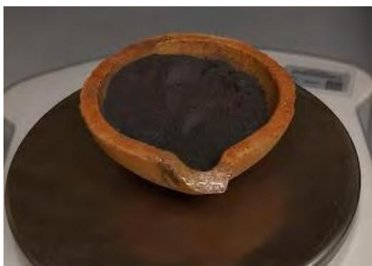
**Fotografía 11. Crisol de barro con muestra del concentrado de Pb**
