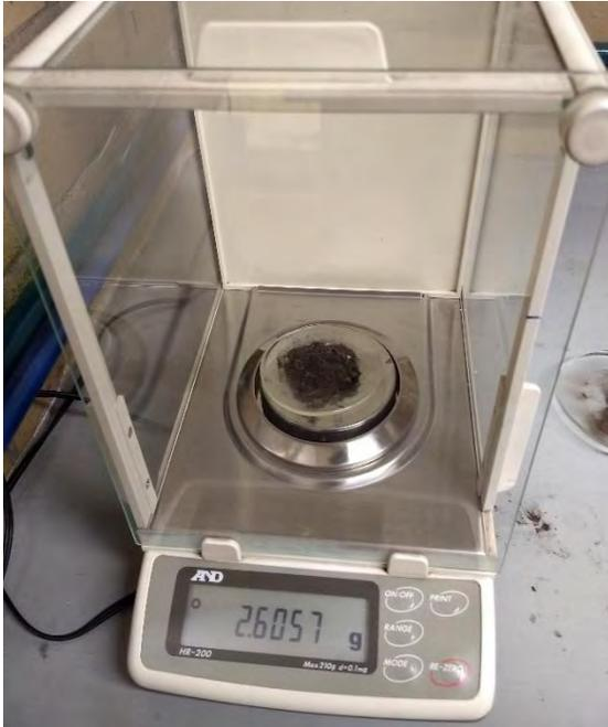
Fotografía 43. Pesado del cobre cementado
