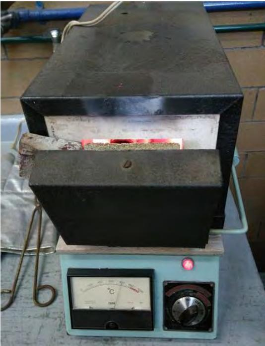
Fotografía 8. Mufla eléctrica utilizada durante la experimentación
