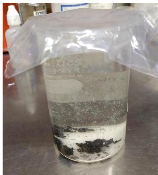
Fotografía 57. Precipitación del cemento de oro y plata
