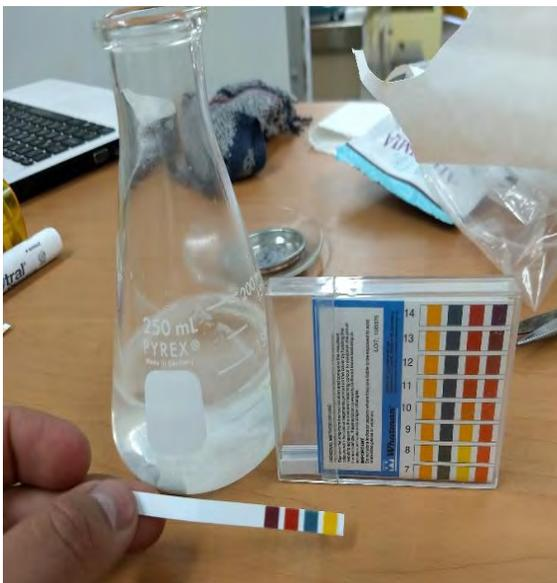
Fotografía 58. Medición de pH 14 del proceso de cementación
