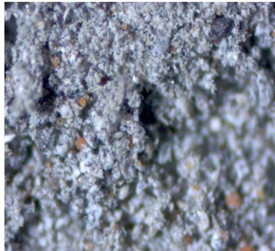
Fotografía 5. Superficie del residuo posterior a la lixiviación con ácido sulfúrico, la presencia de óxidos disminuye radicalmente.
