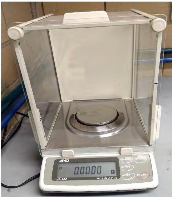
Fotografía 17. Balanza analítica AND HR200
