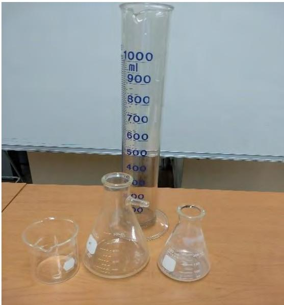
Fotografía 19. Material de vidrio: Probeta, vaso de precipitado y matraz Erlenmeyer
