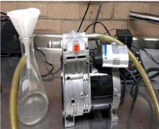
Fotografía 41. Filtración al vacío del cemento de cobre
