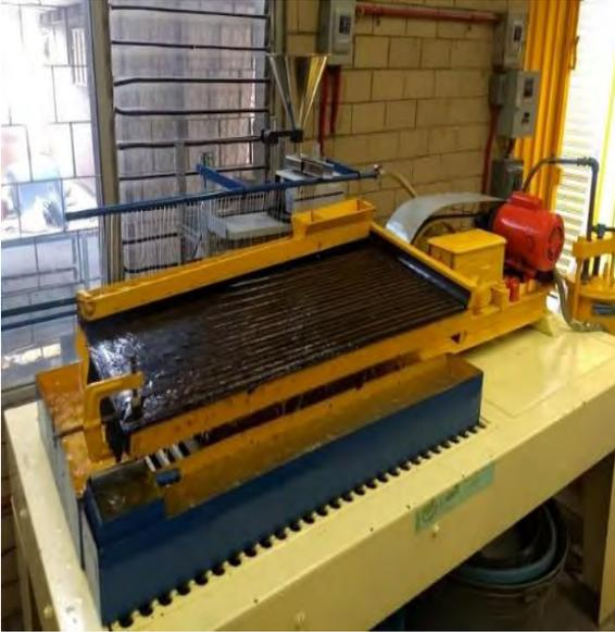
Fotografía 49. Puesta en marcha de las pruebas de concentración gravimétrica
