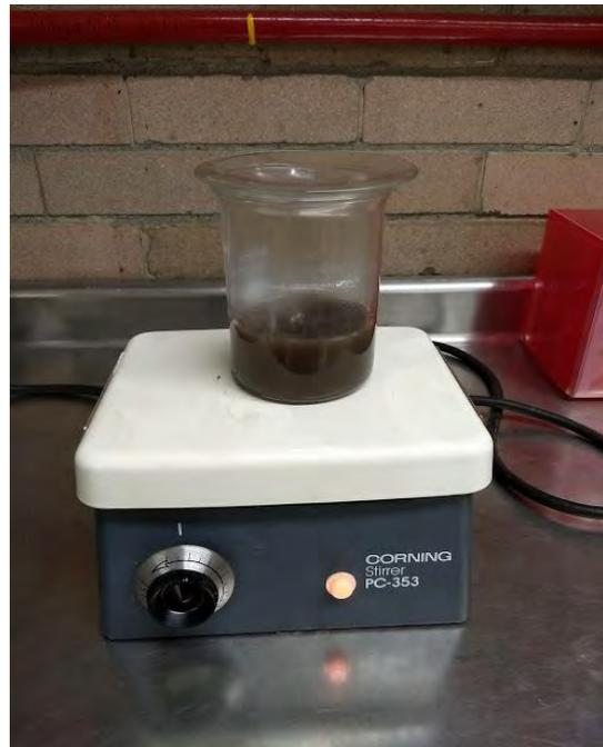
Fotografía 20. Lixiviación de la muestra en ácido acético (prueba preliminar)
