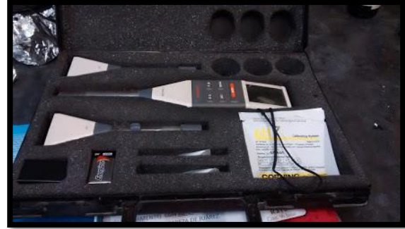
Fotografía 10. Conductímetro usado para la estimación de TDS y conductividad.
