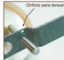
Para jalar el sujetador y colocar los tornillos de ajuste.
