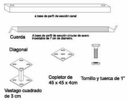
DETALLE 05 MATERIALES PARA ESTRUCTURA TRIDIMENSIONAL D5
