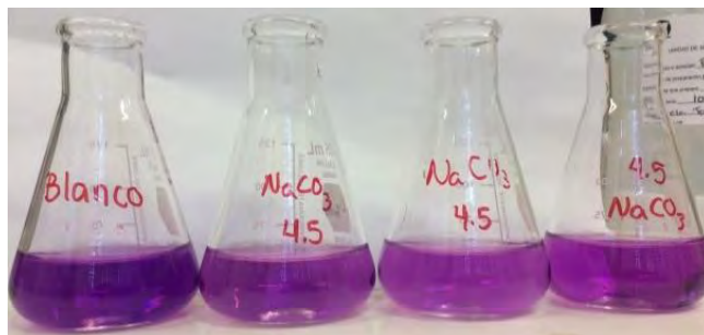
Figura A.4. Dureza de calcio después de ablandamiento con carbonato de calcio ( \text{Na}_2\text{CO}_3 ) ya titulados.
