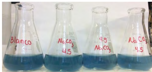
Figura A.2. Dureza total después de ablandamiento con carbonato de calcio ( \text{Na}_2\text{CO}_3 ) ya titulados.
