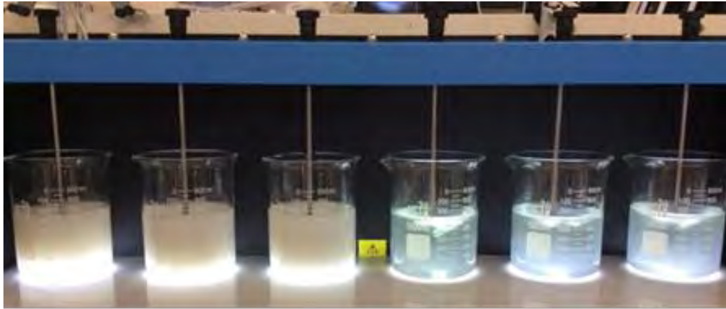
Figura 2.1. Tratamiento en prueba de jarras de M201.
