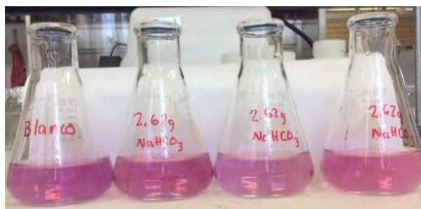
Figura A.1. Muestra para determinar dureza total de tratamiento con \text{NaHCO}_3 sin titular.
