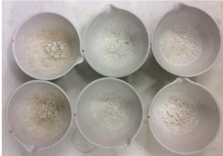
Figura A.6. Sólidos Totales de las muestras ya ablandadas con carbonato de sodio \text{Na}_2\text{CO}_3 en sus diferentes concentraciones.
