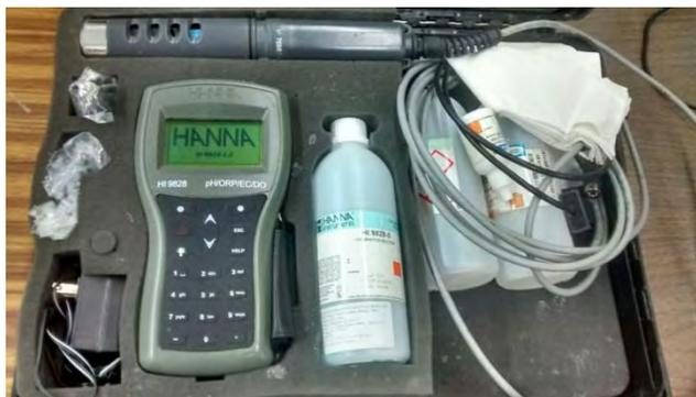
**Figura 7. Equipo multi-paramétrico HANNA modelo HI 9828 PDA**
