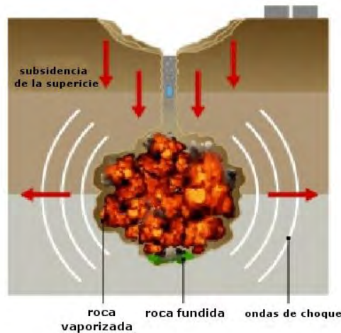
Figura 50. Propagación de las ondas de choque debida a la detonación de una carga explosiva subterránea. Fuente: FAS, Global Security.
